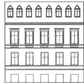
Negativ: Anzahl der Gauben übersteigt Anzahl der Fenster, Gaubenabstand geringer als Breite einer Gaube
